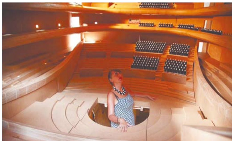
Model akustyczny sali NOSPR-u w skali 1:10
